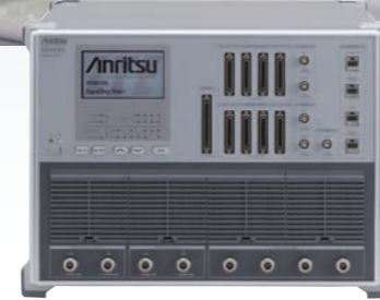
シグナリングテスタ MD8430A (基地局シミュレータ)
